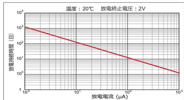
\* 標準容量は20°C環境において標準放電電流で放電した時、終止電圧2.0Vまでの持続時間から求めたものです。
