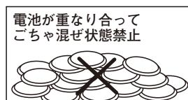
例えば、電池が相互に重なり合ってごちゃ混ぜ状態になった場合、右図のように接触し、電気が流れて電池が発熱、破裂、発火することがあります。
