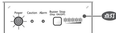
電池残量を確認する場合は、ブザー停止・残量表示スイッチを長押し（約5秒）してください。電池残量インジケータが点灯し残量を表示します。
