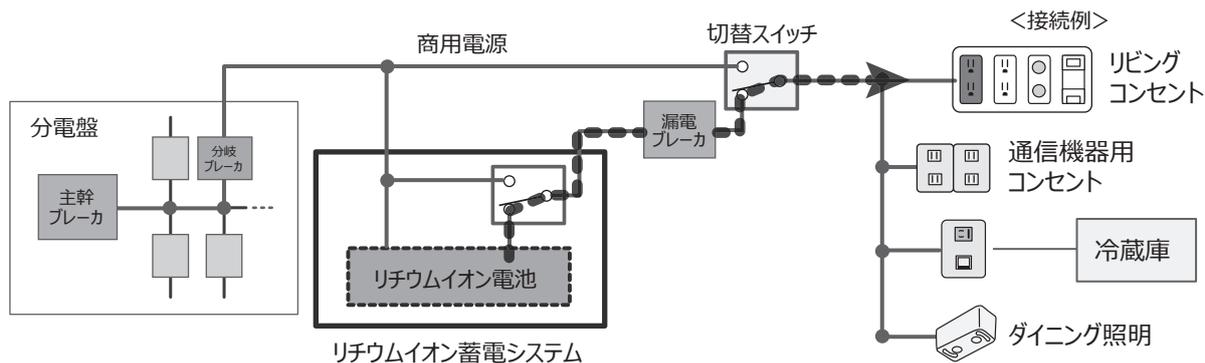
※ 1：本装置に異常がある場合は、停電が発生してもバックアップ運転に切り替わりません。詳細は、「装置の動作状態」
