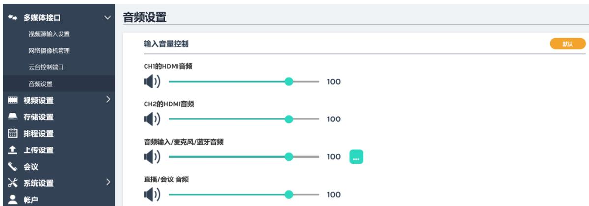
**输入音量控制：**针对不同音频来源进行音量调整。调整范围为 0-125。音量条数字代表目前声音的能量值。此外，您也可以点击 图标设定为静音。
