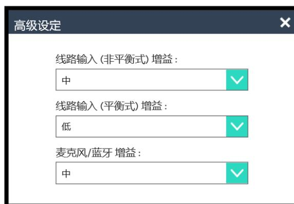
高级设定包含非平衡式线路输入增益、平衡式线路输入增益、麦克风与蓝牙增益供调整。
