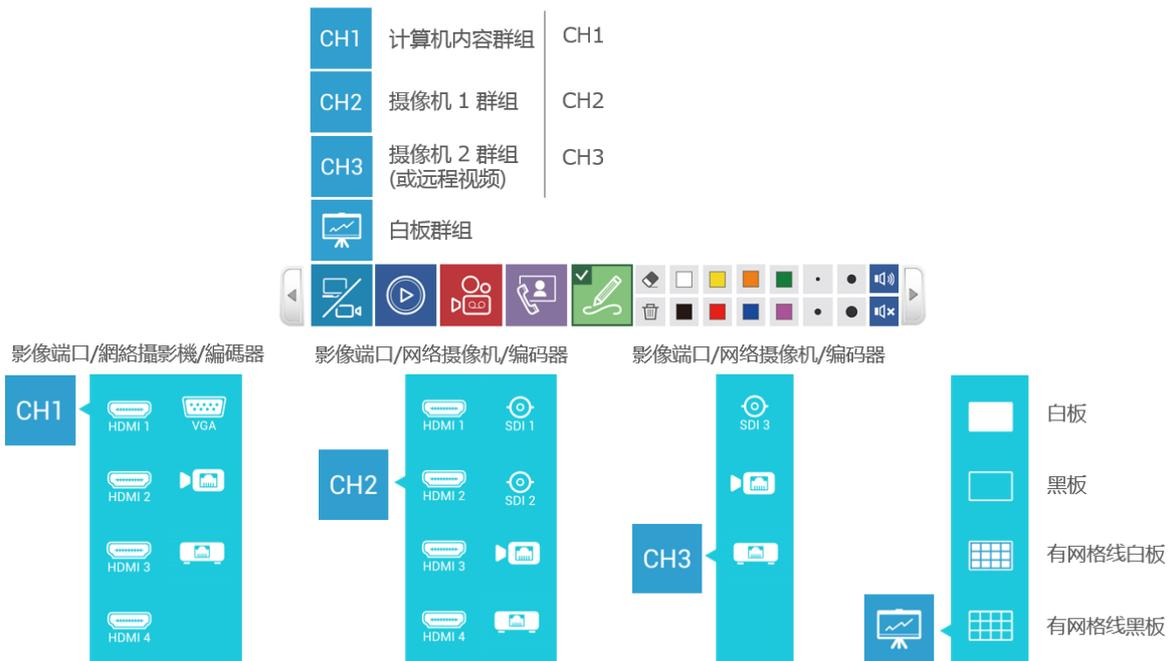
在会议模式中，CH3 的视频源将被远程的画面取代以方便进行互动沟通。使用者此时将无法切换 CH3 视频源在显示屏上分享。
