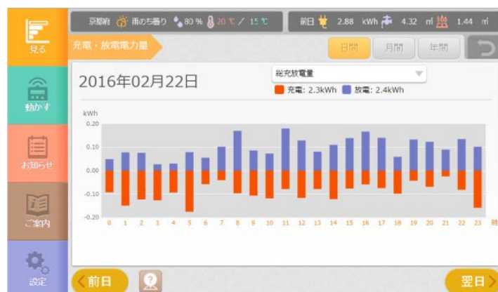
充電・放電電力量（総充放電量）の表示例
